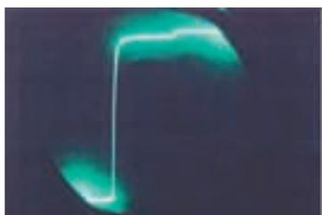
Fig. 4 mostra a resposta do RG179, um cabo de nível, de 75 ohm coaxial feito de acordo com as Especificações Standards US Militares MIL-C-17D. Repare que os dois cabos da Supra têm uma performance igualmente limpa. Note que todos estão montados com fichas BNC de 75 ohm.
