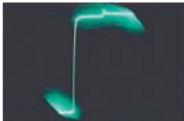
Fig. 5 mostra o Trico com fichas phono/RCA. Poderia ser qualquer um dos outros cabos. A adaptação de impedancia inconstante das fichas RCA a alta RF causa reflexões (vistas como 'spikes positivos'), este tipo de comportamento é precisamente o motivo pelo qual as fichas BNC foram inventadas em 1940 como terminais de RF coaxiais sérios, para substituírem a 'falhada' primeira geração de fichas, nomeadamente RCA e tipos de UHF. Então a RCA foi reciclada como ficha de audio.
