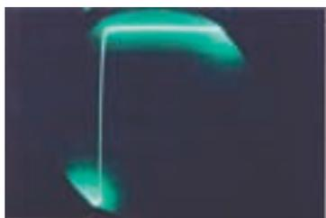
Fig. 1 mostra a referência com carga de 50 ohms e ligação especial de terra, actuando como quase pura resistência a todas as frequências até acima dos 2GHz (alta RF).
