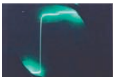
Figure 3. Réponse du câble Supra AV-3. Voir également ci-dessus.
