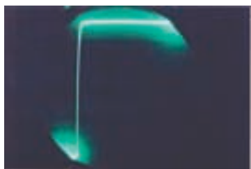
Figure 1. Réponse référence, avec un ensemble câble et prises 50 Ohms, agissant comme une résistance pratiquement pure à toutes les fréquences, jusqu'à plus de 20 GHz (Très hautes fréquences radio RF).
