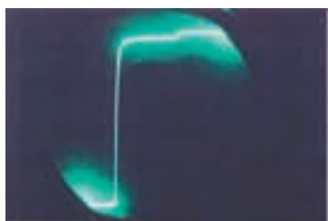
Figure 4. Réponse du câble RG179, un câble coaxial 75 ohms, très haute qualité, répondant aux normes militaires US MIL-C-17D. Notez que les deux câbles Supra donnent des résultats quasiment similaires. Notez également que tous sont équipés de prises BNC 75 ohms.
