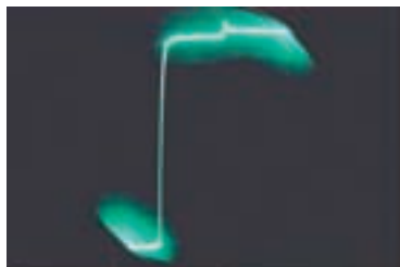
Figure 5. Câble Trico équipé de prises Phono/RCA. Le résultat serait identique avec un autre type de câble. Les prises RCA présentent une impédance fluctuante entraînant des réflexions dans les hautes fréquences RF (visible ici sous la forme de la «pointe positive»). C'est d'ailleurs à cause de ce problème que les prises BNC furent inventées dès 1940, pour les liaisons coaxiales RF (fréquences radio) sérieuses, en remplacement des «mauvaises» prises de première génération, appelées RCA et UHF. C'est alors que les prises RCA furent recyclées comme prises purement audio.
